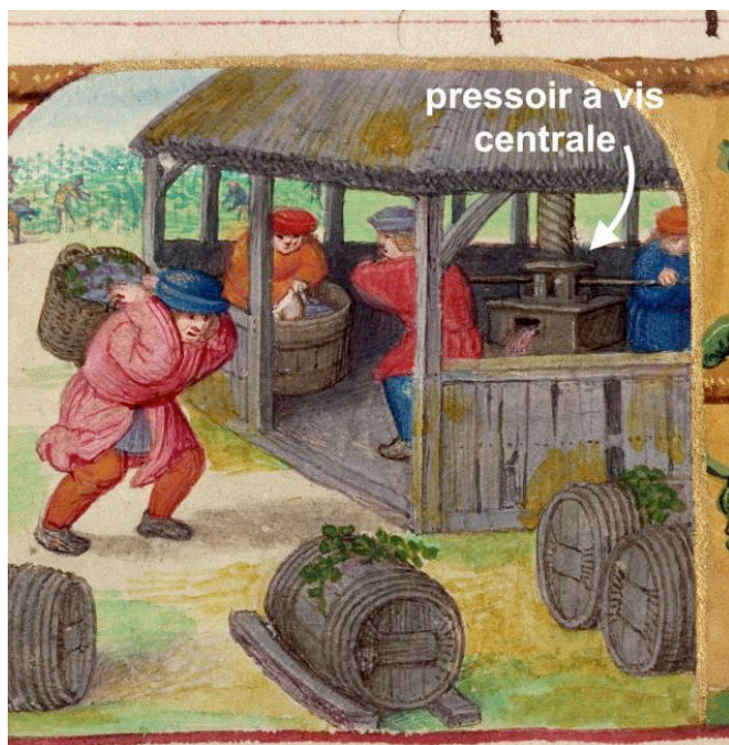
Fig. E 29 - Vinification près des vignes utilisant un pressoir à vis centrale sous abri : deux hommes exercent une poussée vigoureuse sur la barre encastrée dans la vis (1510-1525) (France, Rouen. Bibliothèque municipale, Ms. 3028 f. 010v.).
